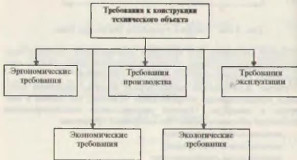
Рис 3.07. Структурная схема системы требований к конструкции технического объекта
