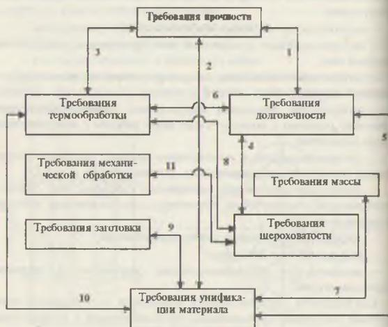
Рис. 3.04. Взаимосвязи между основными требованиями, предъявляемыми к конструкции детали:
