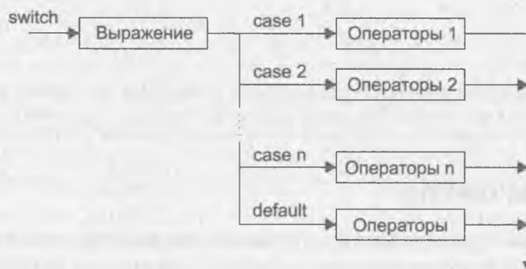
Рис. 1.7. Структурная схема оператора switch
