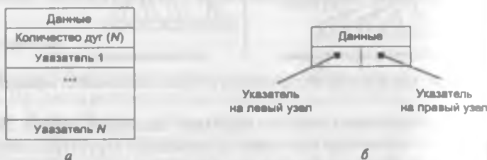
Рис. 10.10. Структура представления узлов и дуг графа: a — узлы; б — дуги
