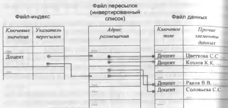
Рис. 10.28. Пример реализации инвертированного индекса
