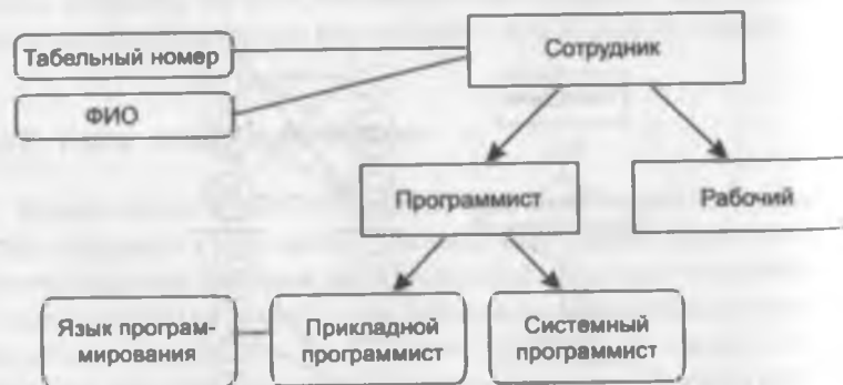
Рис. 5.4. Пример иерархии типов сущностей
