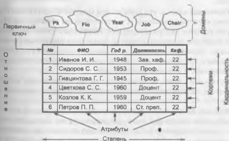
Рис. 2.7. Основные понятия реляционной модели
