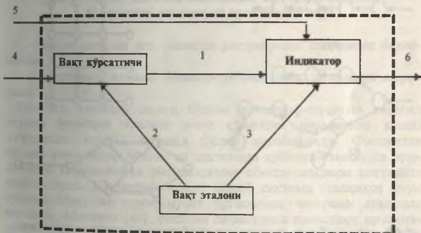
1.07- чизма. Системанинг тузилиш тарзи «синхронловчи соат»: 1, 2 ва 3 — система ичидаги муносабат (алоқа)лар; 4 ва 5 — кириш; 6 — чиқиш.
