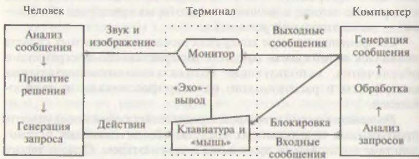
Схема организации взаимодействия компьютера и пользователя
