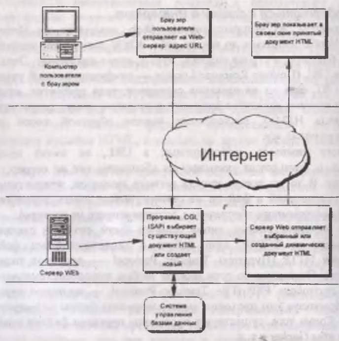
Рис.1.Схема формирования динамических документов HTML с помощью CGI и ISAPI
