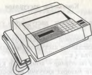
6-расм. Факс-модем — маълумотларни узатиш ва қабул қилиш қурилмаси.
