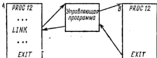
Рис. 29. Схема действия микрокоманды LINK
