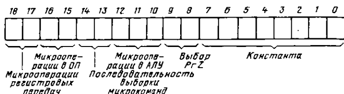
Рис. 9.4. Формат микрокоманды учебного процессора при горизонтально-вертикальном микропрограммировании
