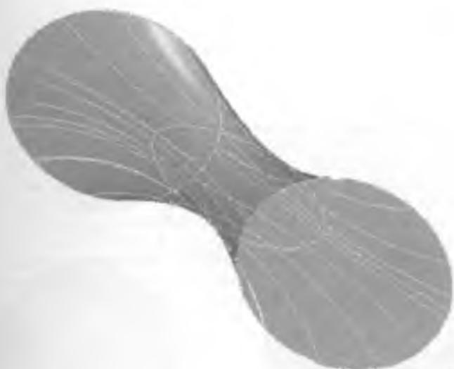
2.1 19-расм. "Loft" имконияти ёрдамида яратилган шакл кўриниши
