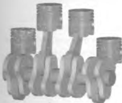
6.3.5–расм. Шатун-Поршень-Палец-тирсакли вал бирикмаси
