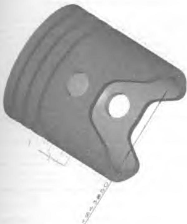
4.2 10-расм. Тайёр Поршень детали кўриниши
