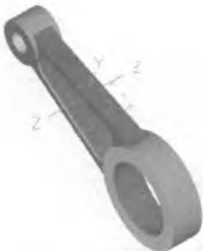
4.1.16-расм Тайер шатун кўриниши
