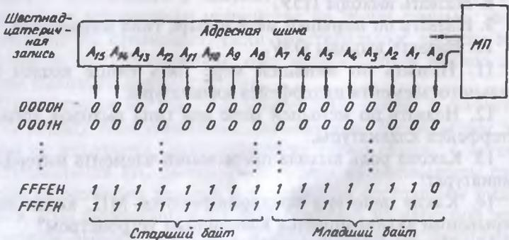
Рис. 4.2. Адресная система микро-ЭВМ.
