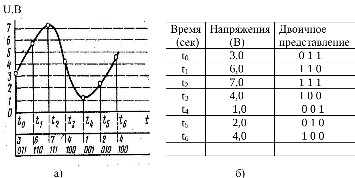
Рис.3.4.1. Иллюстрация сигнала, квантованного по амплитуде и времени, удобная для ввода в ЭВМ. а- дискретизация и квантование сигнала; б- кодирование сигнала.
