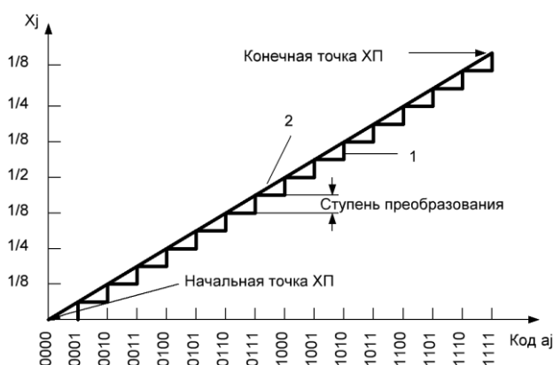
Рис.3.4.12. Номинальная ХП 4-разрядного двоичного ЦАП с однополярным входным сигналом: 1- характеристика преобразования ЦАП; 2-прямая, соединяющая начальную и конечную точки ХП.
