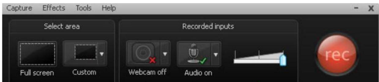
Если нажата первая кнопка слева Full Screen (Весьэкран), то тогда будет записываться весь Рабочий стол, включая Панель задач. Если выбрана кнопка Custom, то тогда можно выбрать произвольную область экрана.
