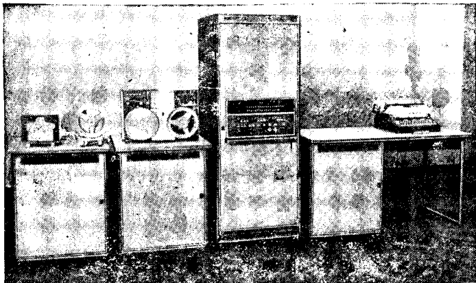
Рис. 6.7. Внешний вид управляющего вычислительного комплекса М-7000.
