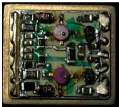
Рисунок 2 Конструктивное исполнение балансного смесителя на полевых транзисторах.
