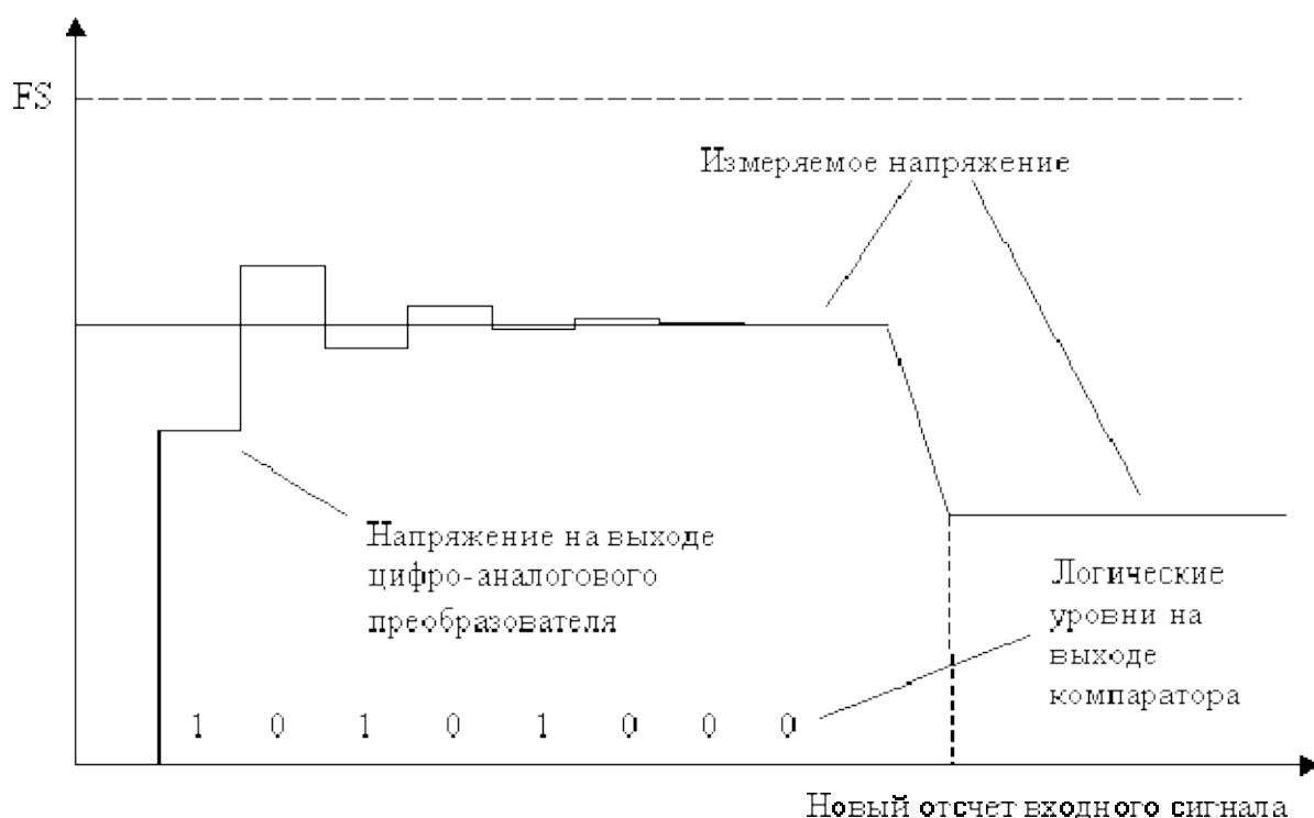
Рисунок 1. Временные диаграммы напряжений на входах компаратора АЦП последовательного приближения.
