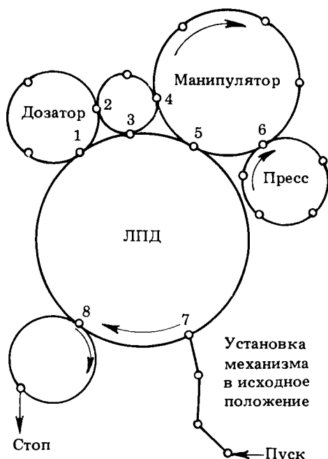
Рис. 2.22. Многопетлевая цикловая система.
