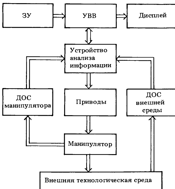
Рис. 10.1. Обобщенная функциональная схема системы управления роботом.
