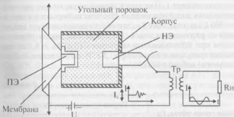
Рис. 1.14. Устройство угольного микрофона
