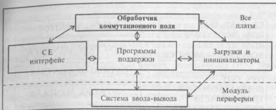
Рис. 7.10. Распределение функциональных блоков ОС по различным элементам управления модулями оборудования
