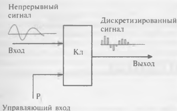
Рис. 2.5. Процесс дискретизации на примере электронного ключа
