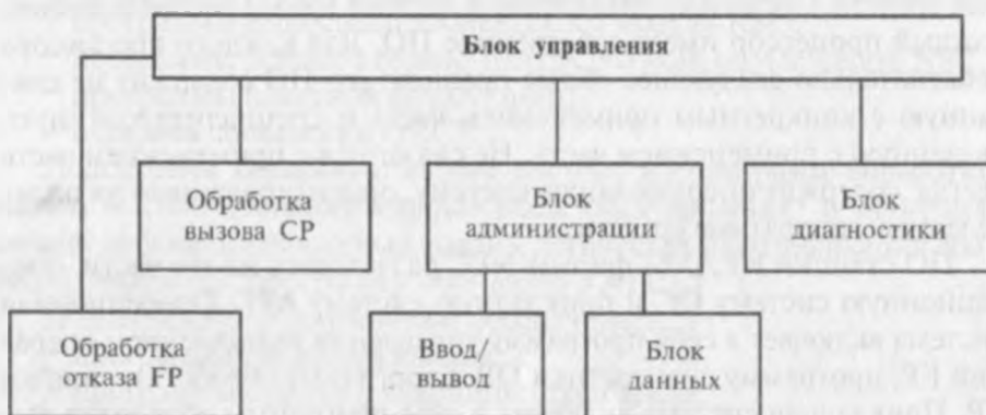
Рис. 7.3. Архитектура ПО станции NEAX-61
