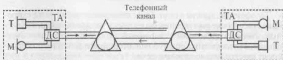
Рис. 1.10. Телефонный тракт с 2-проводными и 4-проводными участками
