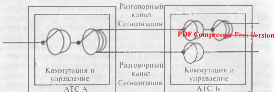
Рис. 3.12. Упрощенное представление способов сигнализации непосредственно по телефонному каналу
