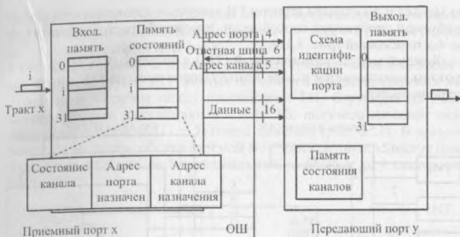
Рис. 8.10. Блок-схема коммутации между приемным и передающим портами DSE
