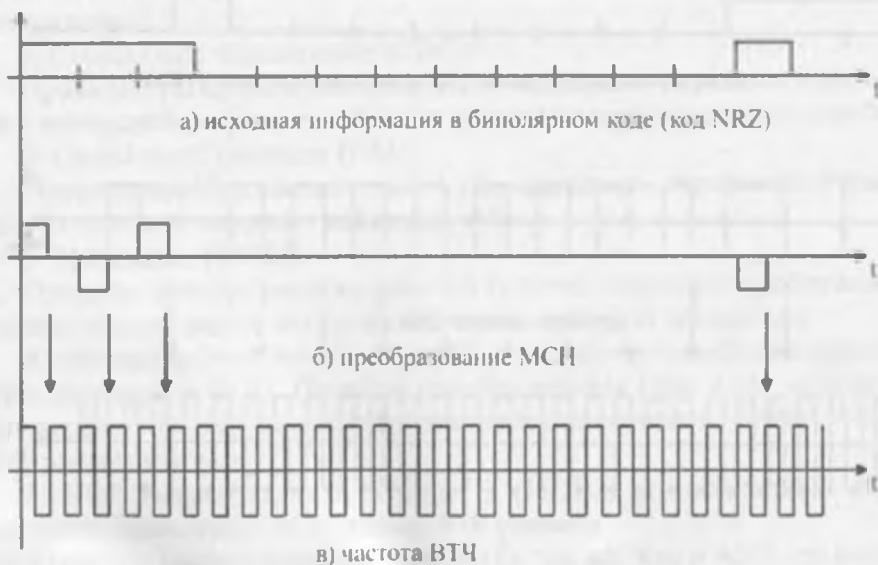
Рис. 4.16. Временные диаграммы преобразования AMI
