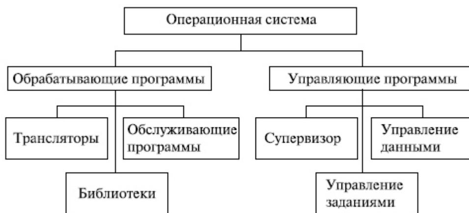
**Рис. 9.1.** Структура общесистемного программного обеспечения САПР
