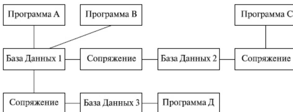
Рис. 10.2. Структура программного обеспечения при частных БД
