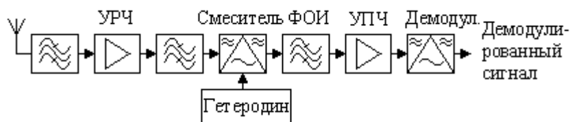
Рисунок 2. Структурная схема супергетеродинного радиоприемника.
