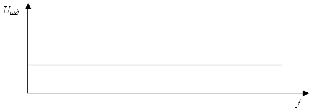
Рисунок 2. Зависимость уровня шумов квантования АЦП от частоты.
