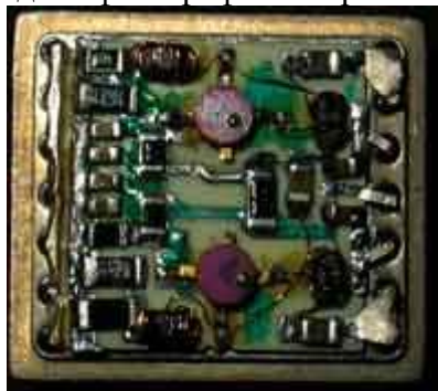
Рисунок 2 Конструктивное исполнение балансного смесителя на полевых транзисторах.
