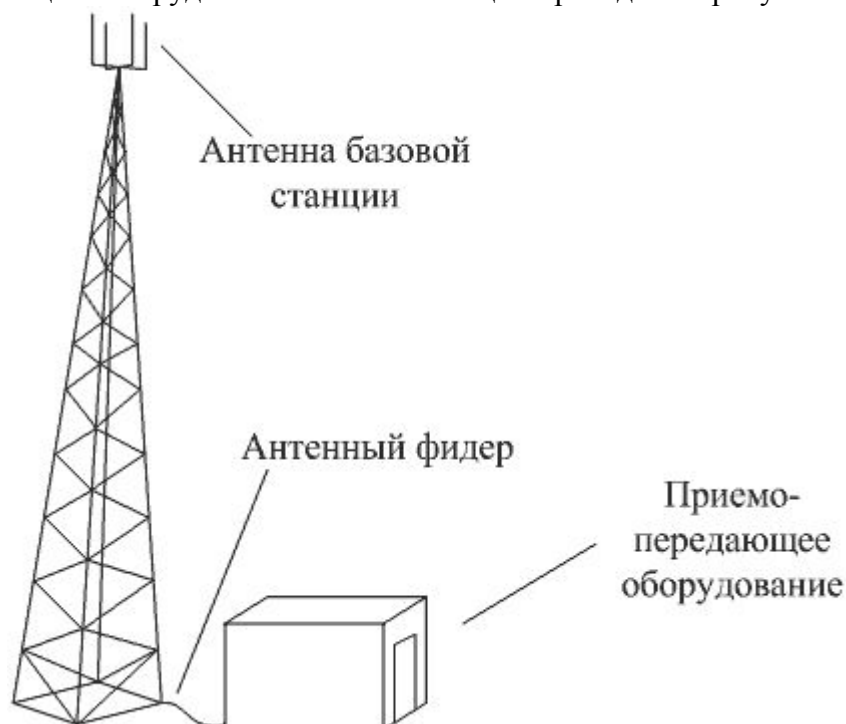
Рисунок 1 Взаимное расположение антенны и приемо-передающего оборудования базовой станции
