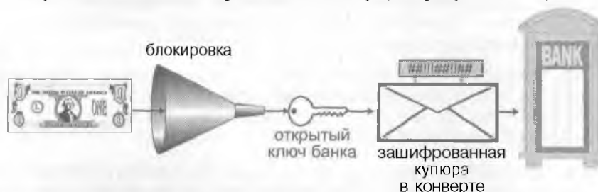
Рисунок 11.11. Пользователь умножает номер купюры на фактор блокировки, зашифровывает полученное значение и пересылает банку.
