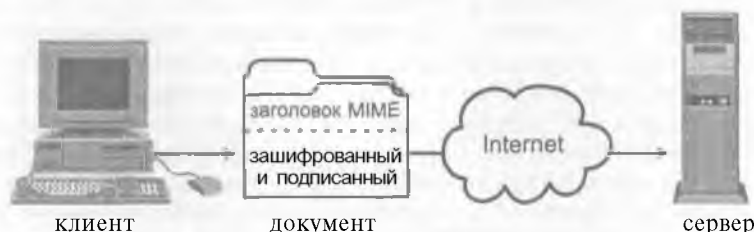
Рисунок 7.1. S-HTTP добавляет к HTTP средства обеспечения безопасности.
