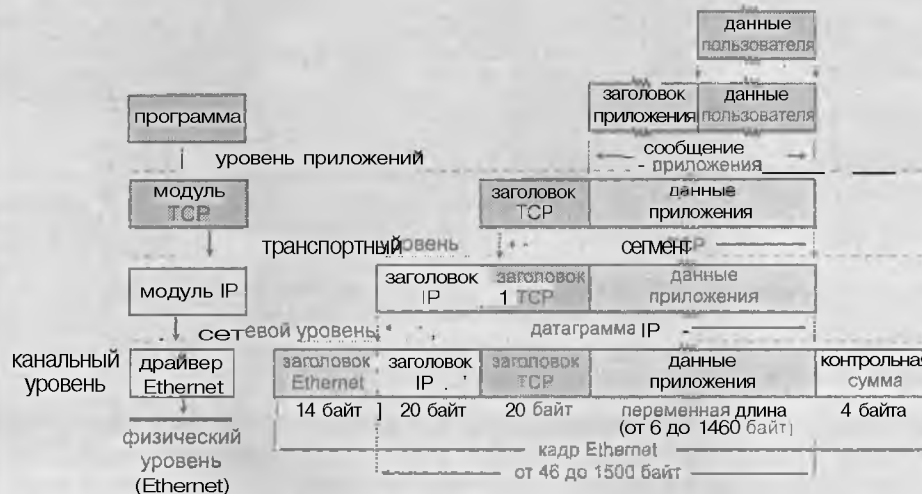
Рисунок 2.6. Инкапсуляция сообщения с помощью TCP в сети Ethernet.
