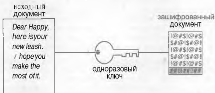
Рисунок 4.14. Зашифрованный одноразовый ключ пересылается вместе с шифровкой.
