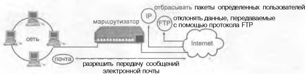
Рисунок 3.2. Экранирующий маршрутизатор фильтрует пакеты, выходящие и входящие в сеть.
