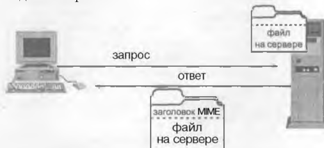
Рисунок 6.1. Сервер добавляет к файлу заголовок MIME .
