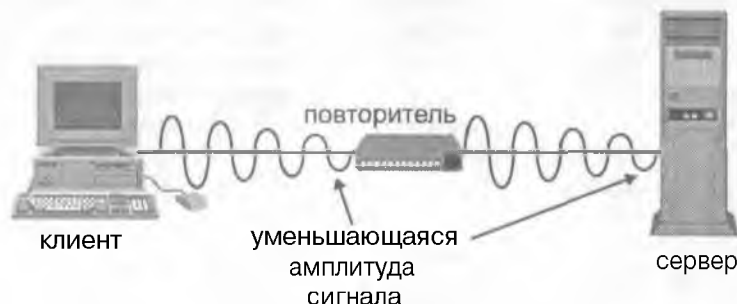
Рисунок 2.18. Для борьбы с затуханием в сетях используются повторители.
