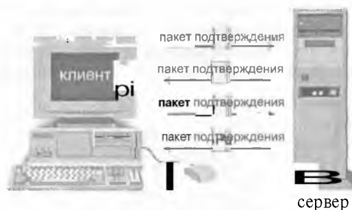
Рисунок 9.9. Бесконечный цикл генерации пакетов TCP ACK.
