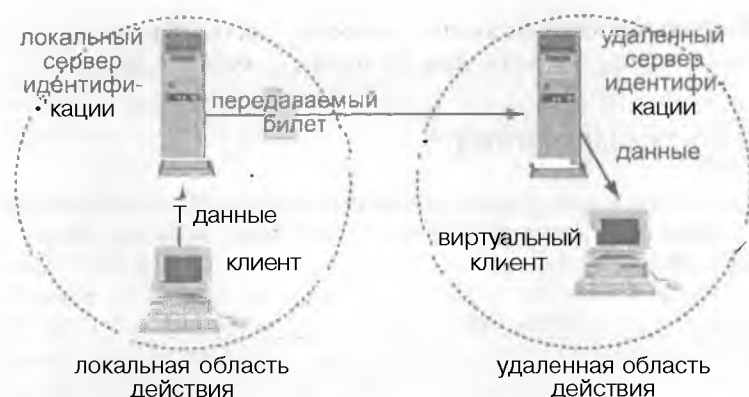
Рисунок 10.15. Обработка передаваемых билетов в системе Kerberos.
