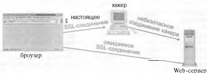
Рисунок 9.25. Компьютер хакера подменяет безопасное соединение.
