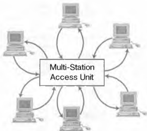
Рисунок 2.17. IBM Token Ring присоединяет каждый узел к серверу двумя кабелями.
