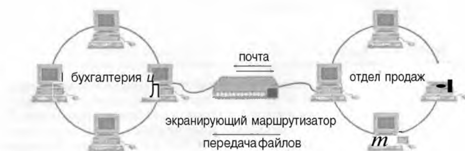
Рисунок 3.4. Экранирующие маршрутизаторы позволяют контролировать трафик сети без изменения приложений клиента или сервера.
