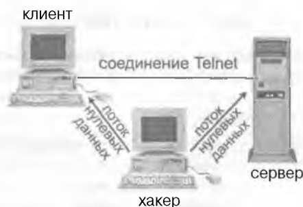
Рисунок 9.13. Хакер передает нулевые данные обеим сторонам соединения.
