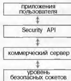
Рисунок 8.16. Security API значительно расширяет архитектуру SSL.
