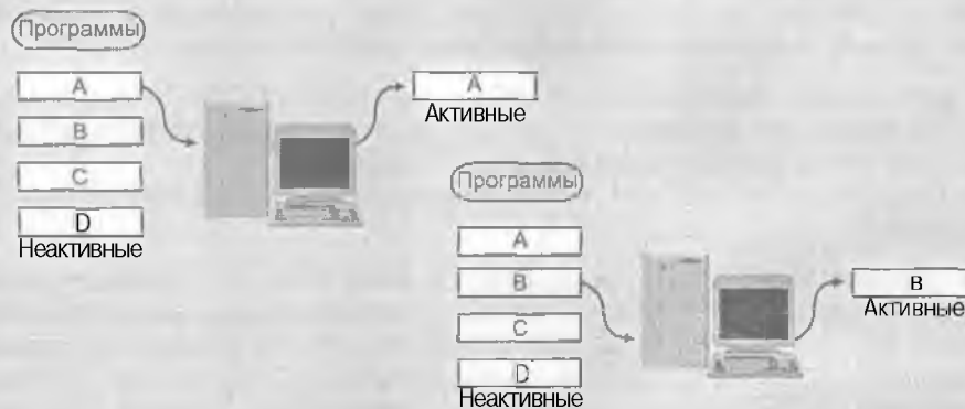
Рисунок 1.1. Многозадачная операционная система обрабатывает потоки по одному.
