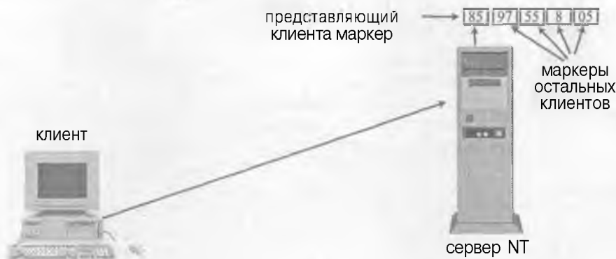
Рисунок 15.5. Для представления пользователя операционная система создает маркер.
