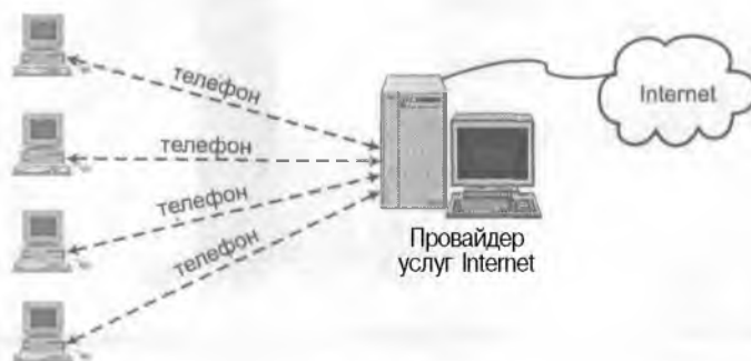
Рисунок 1.8. Подключение к Internet с помощью провайдера.
