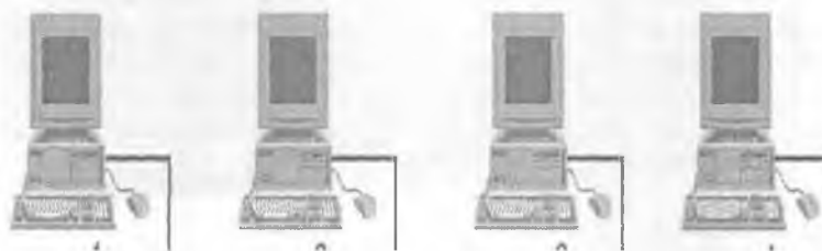
Рисунок 2.16. Сеть, использующая соединение «шина».
