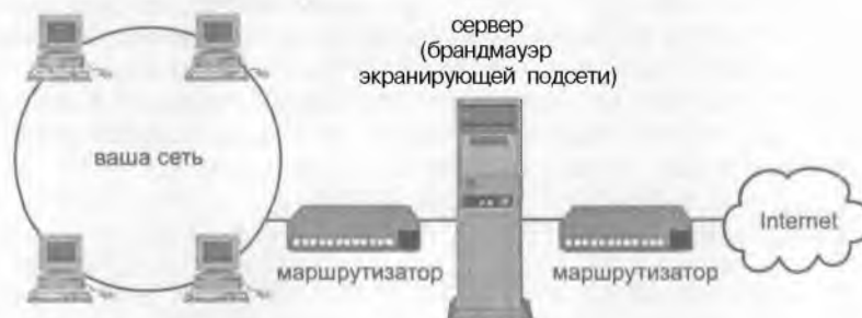
Рисунок 3.13. Брандмауэр экранирующей подсети.
