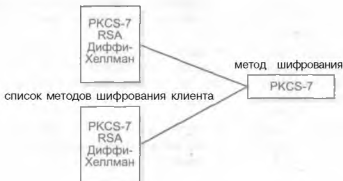
Рисунок 7.2. Сервер сравнит список методов шифрования и выберет PKCS-7.
