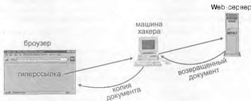
Рисунок 9.22. Принципиальная схема атаки подмены Web.
