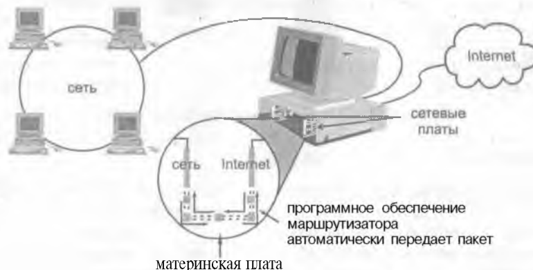
Рисунок 3.11. Данные обходят брандмауэр в сдвоенном хосте.
