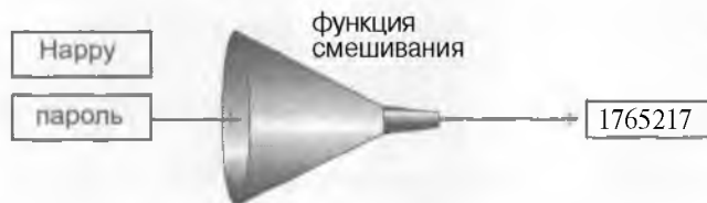
Рисунок 15.10. Операционная система преобразует пароли в смешанное значение.
