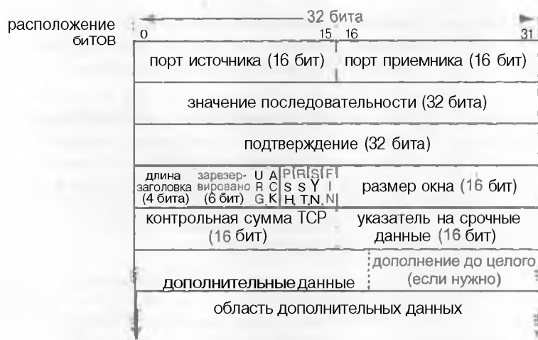
Рисунок 2.11. Структура сегмента (или сообщения) TCP.
