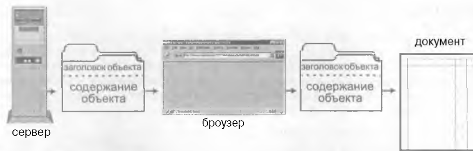
Рисунок 6.17. В поле заголовка объекта описывается специфика полученного документа.
