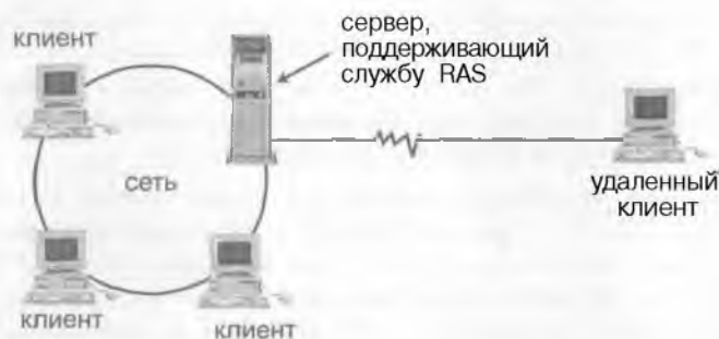
Рисунок 15.15. Удаленный пользователь присоединяется к серверу с помощью службы RAS.
