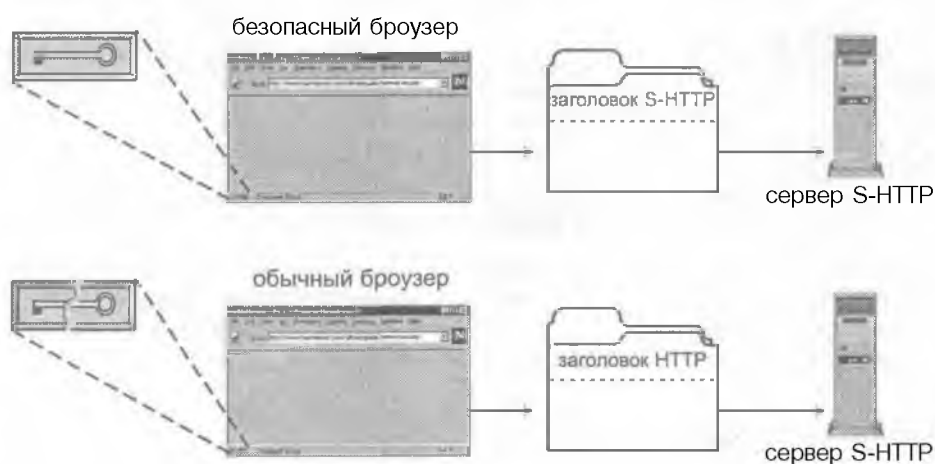
Рисунок 7.13. Так безопасный и обычный браузеры могут общаться с безопасным сервером.
