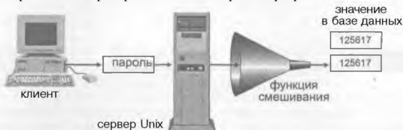
Рисунок 17.3. Передача и преобразование пароля.
