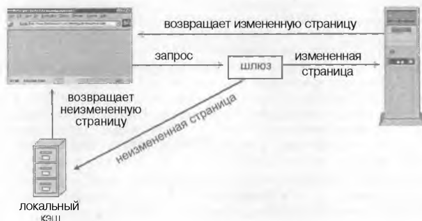
Рисунок 6.14. Получение доступа к странице при помощи условного метода GET .
