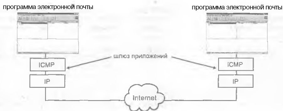
Рисунок 2.22. Шлюзы приложений преобразуют данные для использования в другой сети.
