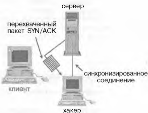
Рисунок 9.12. Хакер перехватывает пакет и устанавливает синхронизированное соединение.
