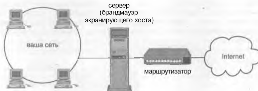
Рисунок 3.12. Брандмауэр экранирующего хоста.
