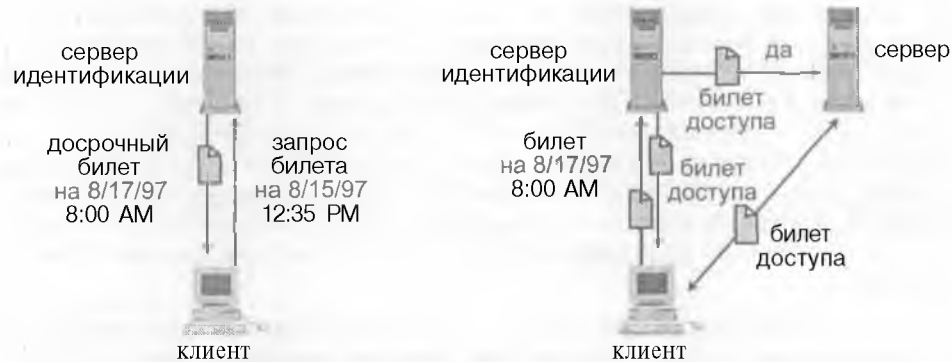
Рисунок 10.14. Система Kerberos обслуживает досрочные билеты.
