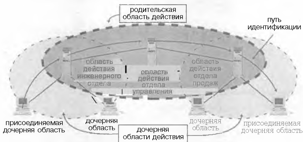
Рисунок 10.12. Путь идентификации между двумя не присоединенными дочерними областями.
