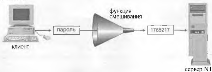
Рисунок 15.11. Преобразование и передача смешанного значения.
