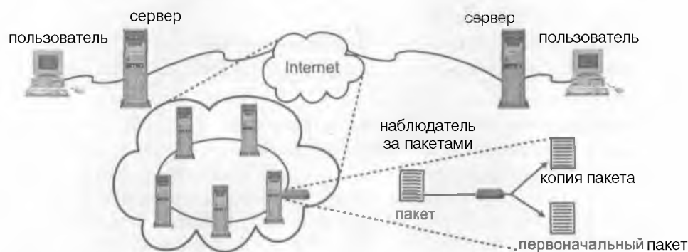
Рисунок 1.16. Наблюдатель за пакетами перехватывает и копирует пакеты.
