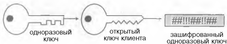
Рисунок 7.10. Сервер пересылает клиенту одноразовый ключ, зашифрованный при помощи открытого ключа клиента.
