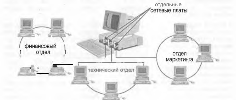
Рисунок 3.3. Использование компьютера с множеством сетевых карт для защиты нескольких соединенных сетей.
