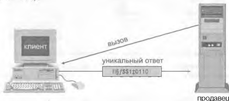
Рисунок 11.9. Система вызовов и ответов получает от покупателя дополнительную информацию.
