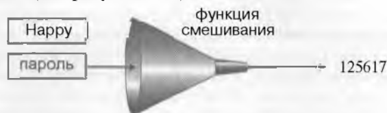
Рисунок 17.2. Преобразование пароля в смешанное значение.
