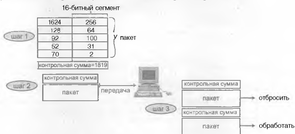
Рисунок 2.19. Пример вычисления контрольной суммы.
