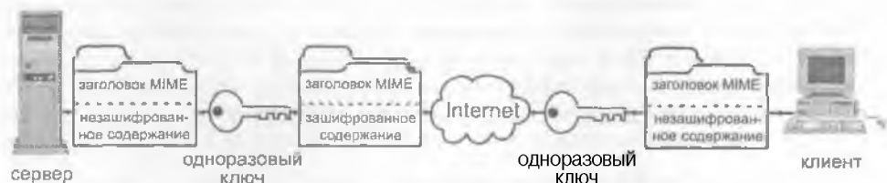
Рисунок 7.15. Обмен сообщениями при помощи механизма обмена ключами во время передачи.
