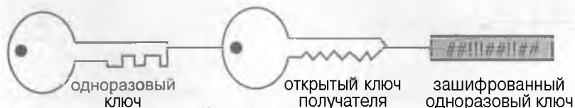
Рисунок 4.13. Программа шифрования кодирует одноразовый ключ при помощи открытого ключа адресата.
