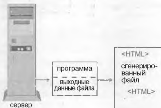
Рисунок 20.2. Программа записывает данные в ASCII-файл.
