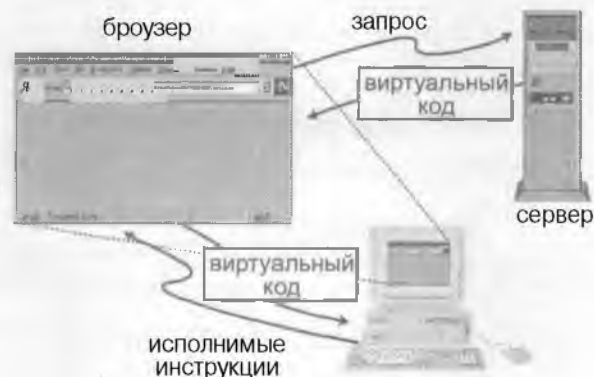
Рисунок 13.5. Взаимодействие между браузером, сервером и виртуальной машиной Java.
