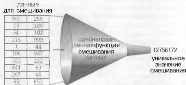
Рисунок 5.1. Файл проходит через функцию смешивания, а в результате получается некоторое уникальное значение.
