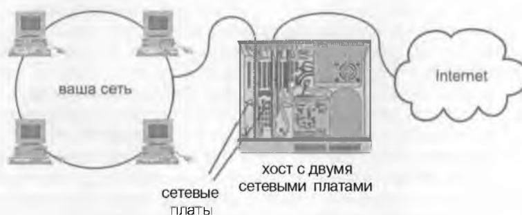
Рисунок 3.10. Брандмауэр сдвоенного хоста.
