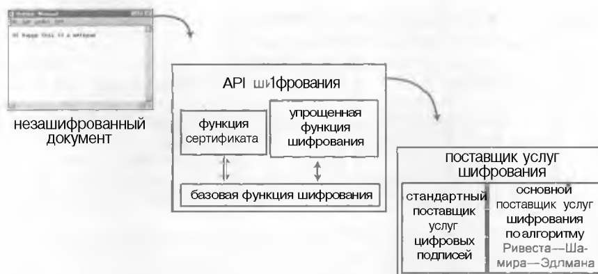
Рисунок 4.18. Модель шифрования для использования интерфейса CryptoAPI.
