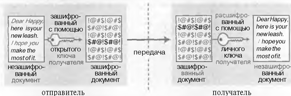
Рисунок 4.10. Обмен информацией в системе с открытым ключом.
