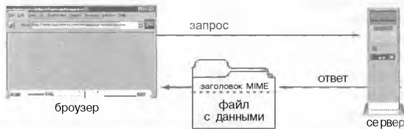
Рисунок 6.7. Поиск и извлечение ресурсов Web с использованием HTTP.
