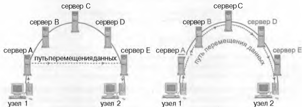
Рисунок 2.24. Различия между каналом точка—точка и широковещательным каналом.
