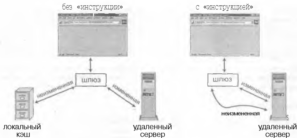
Рисунок 6.15. Работа шлюза по «инструкции» и без нее.
