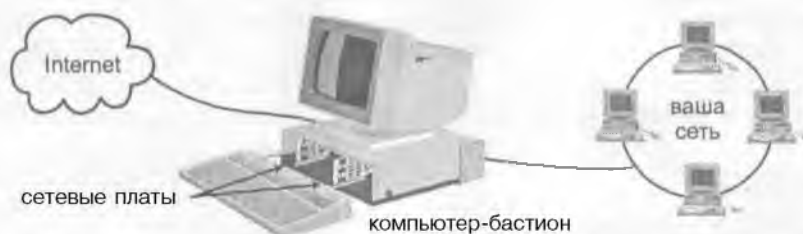
Рисунок 3.1. В качестве компьютера-бастиона можно использовать любой ПК.
