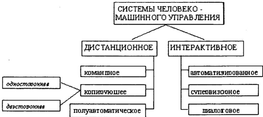
Рис. 2.4. Классификация систем человеко-машинного управления роботом
