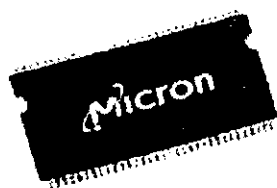
Чип DDR SDRAM в корпусировке TSOP
