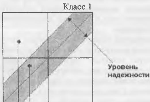
Рис. 7.4. Схема проекции обучающих примеров в двухмерном пространстве при бинарной классификации.
