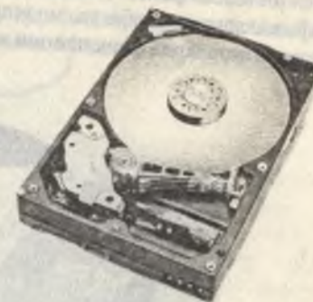
23-расм. Қаттиқ дискга йиғувчи қурилма химоя қобигисиз
