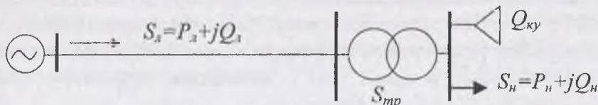
Рис. 4.7. Радиальная схема внутриводского электроснабжения.
