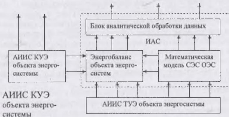
Рис. 5.13. Структурная схема совместного функционирования АИИС КУЭ и АИИС ТУЭ с использованием ИАС по энергоэффективности
