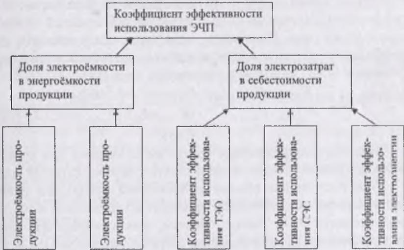
Рис. 5.4. Структура обобщенного коэффициента эффективности использования электрической энергии на производстве.
