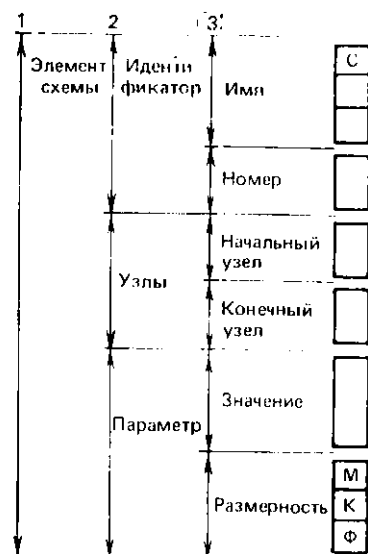
Рис. 1.2. Представление записи в оперативной памяти
