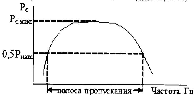
Рис. 30. Определение полосы пропускания
