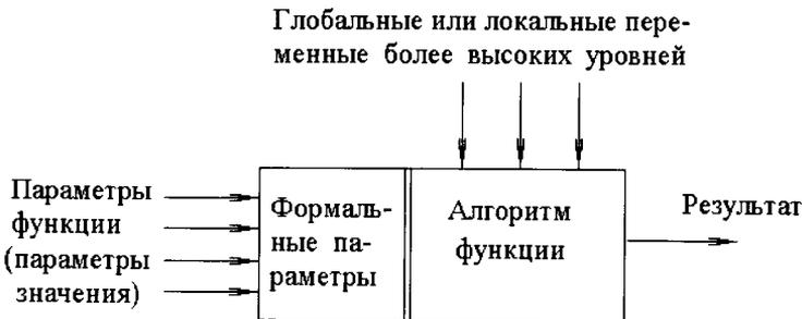
Рис. 14. Структура функции, имеющей входные параметры
