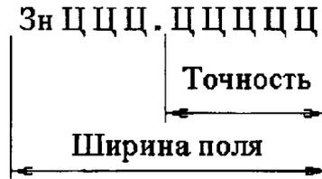
Рис. 1. Схема отображения вещественного числа с фиксированной точкой
