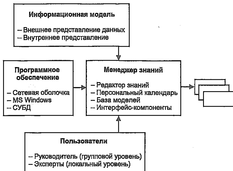
Рис. 7.3. Обобщенная структура мультиагентной системы принятия решений «Multi Expert»
