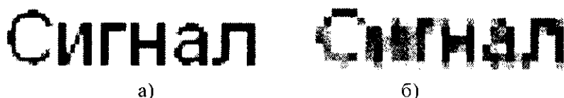
Рис. 3.6. Увеличенное изображение слова «Сигнал», написанное 14 кеглем шрифта Arial при разрешении экрана 1280x1024 (а) и его изображение, полученное с более низким разрешением (б)
