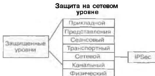
Рис. 5-1, Защита на сетевом уровне
