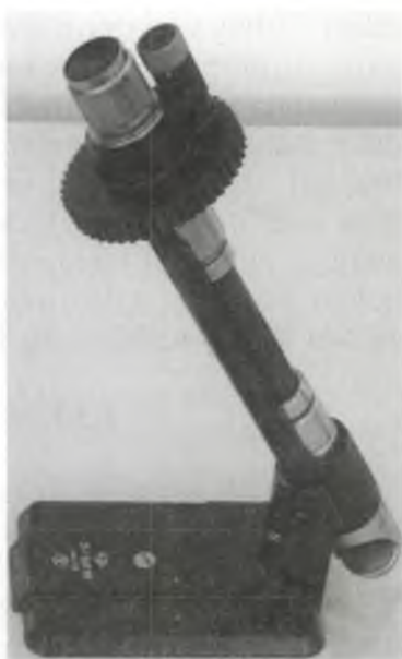
2.16-rasm. П-161М rusumli laboratoriya polarimetri.
