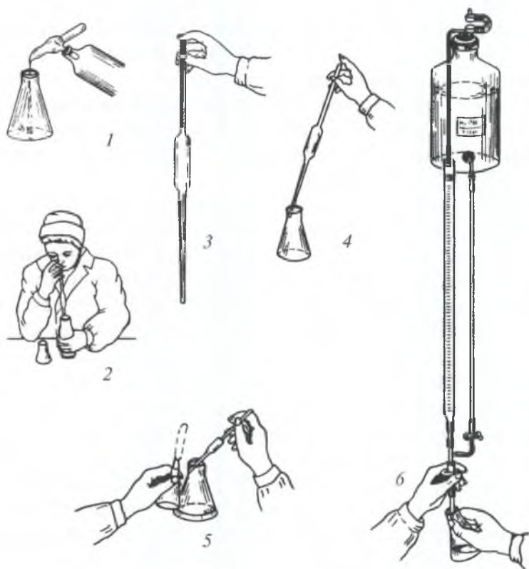
3.3-rasm. Sutning titrlanadigan kislotaligini aniqlash:
