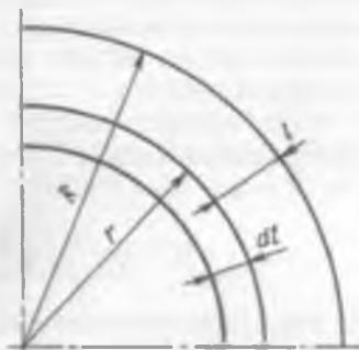
Рис. 8.2. Схема замораживания цилиндрического или сферического тела при перемещении границы раздела:
