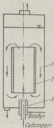
Рис. 27. Ферментатор с форсуночным воздушораспределением:
