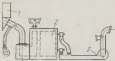
Рис. 39. Участок подготовки сушильного агента в установке для сушки дрожжей с использованием в качестве топлива природного газа:
