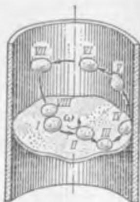
Рис. 5.11. Схема движения клубня в дисковой картофелеочистительной машине
