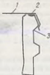
Рис. 12. Схема герметизации обжимной стеклянной тары:
