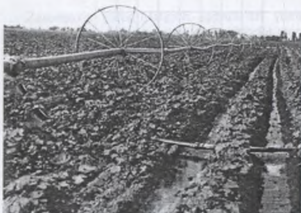
31-rasm. ДКШ-64 «Voljanka» yomg'irlatib sug'orish mashinasi.
