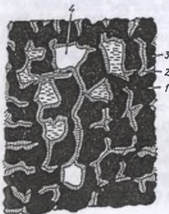
4-rasm. Tuproqdagi muallaq osilib turuvchi suv: 1 — tuproq zarrachalari (mikroagregatlar); 2 — tuproq zarrachalari sirtiga bog'langan pardasimon suv; 3 — sorbsion berk erkin suvning mikroto'planishi; 4 — bo'sh g'ovaklar (A.A. Rode bo'yicha).
