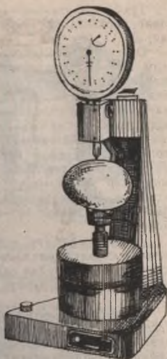
15- расм. Тухум қобиғи таранглигини аниқловчи асбоб (ПУД — 1).
