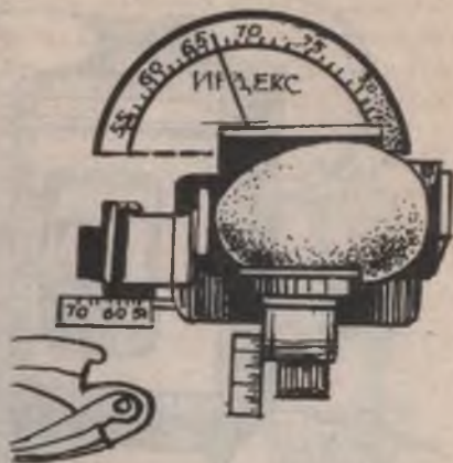
13- расм. Тухум шаклини аниқловчи индексомер ўлчаш асбоби.
