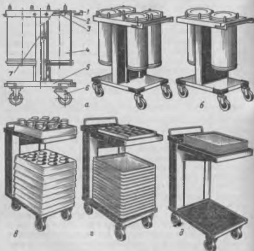
Рис. 6.4 Тележки с выжимным устройством:
