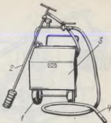
Рис. 134. Установка УОР-1 для откачки рассола:
