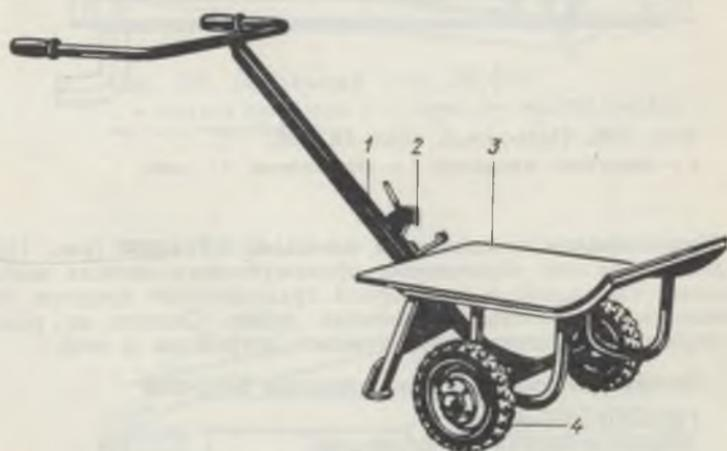
Техническая характеристика подъемного стола ПС-630
