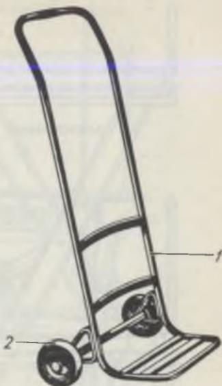
Рис. 107. Грузовая тележка ТГШ-250 для бочек:
