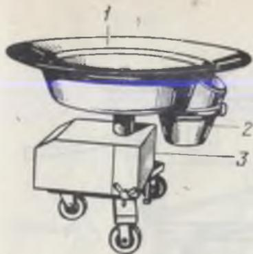
Рис. 133. Устройство УЗК для затаривания квашеной капусты в бочки:
