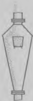
Рис. 81. Устройство для снижения скорости семян в самотечной трубе с помощью цилиндрического стакана
