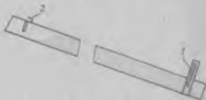
Рис. 82. Устройство для торможения движущихся семян в самотечной трубе:
