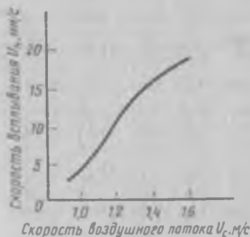
Рис. 25. Влияние скорости воздушного потока на расслоение зерновой массы на сите машины А1-БЗГ
