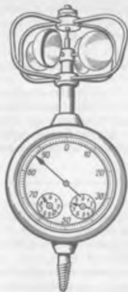
Рис 2.24 Чашечный анемометр
