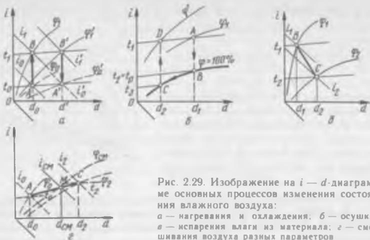
Рис. 2.29. Изображение на  $i-d$ -диаграмме основных процессов изменения состояния влажного воздуха:  $a$  — нагревания и охлаждения;  $b$  — осушки;  $c$  — испарения влаги из материала;  $z$  — смешивания воздуха разных параметров
