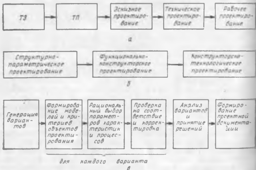
Рис. 47. Общие модели автоматизированного проектирования
