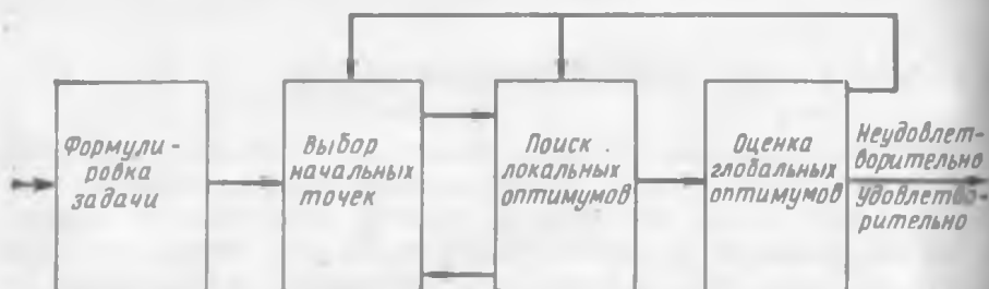
Рис. 49. Блок-схема процесса глобальной оптимизации
