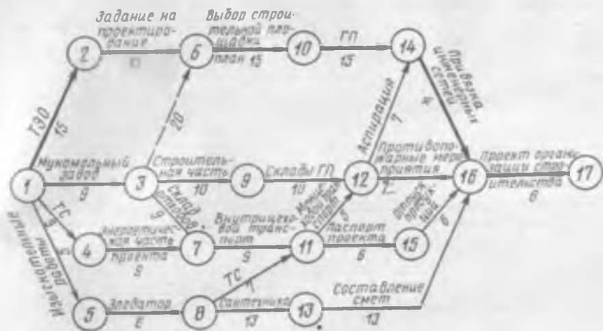
Рис. 45. Исходный сетевой график, ориентированный на работы
