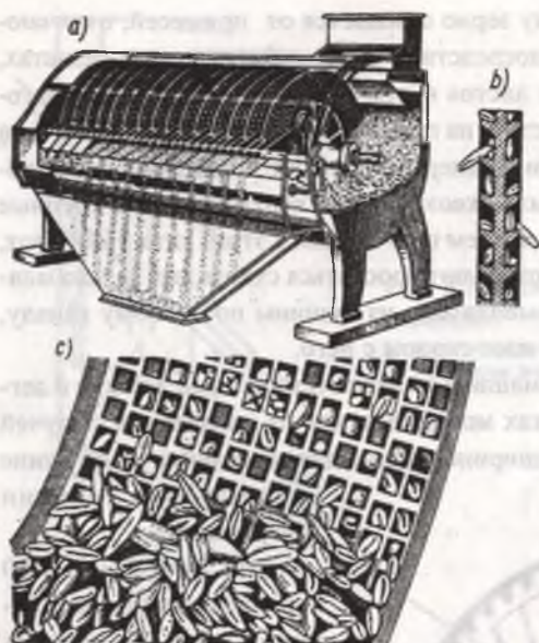
Рис. 3.10. Дисковый триер: а - вид внутри, б, в - разделение длин- ных и коротких частиц
