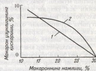
24-расм. Макарон ўлчамларининг қисқариши: 1 – юмшоқ режимда; 2 – қаттик режимда.
