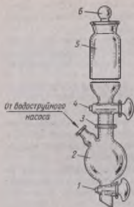
Рис. 68. Фильтрующая делительная воронка: 1, 4 — сливные краны; 2 — приемник экстракта; 3 — соединительный шлиф; 5 — фильтрующая делительная воронка; 6 — пробка стеклянная (притертая)
