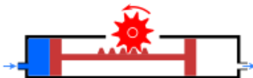
9.23-rasm. Reykali-tishli uzatmali aylanuvchi ikki tomonlama amal qiluvchi pnevmoyuritma sxemasi
