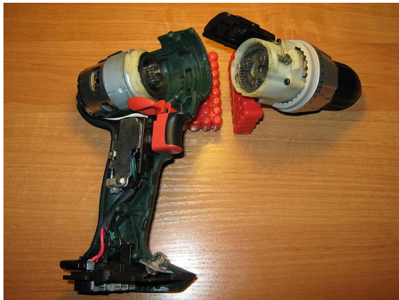
11.14-rasm. Planetar uzatmani drellda qo`llanishi
