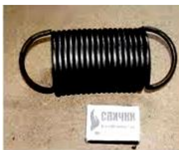
13.1-rasm. «Bavun» firmasining prujinali tormoz qurilmasi
