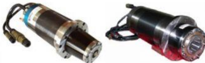
14.13-rasm. Raqamli dasturli boshqariladigan stanoklar uchun asbobni avtomatik almashtirish xususiyatiga ega elektroshpindellar
