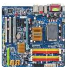
3 - Ona plata (ingl. Motherboard yoki ingl. mainboard - Asosiy plata; materinka) shaxsiy kompyuterning asosiy komponentlari (Markaziy protsessor, tezkor xotira kontrolleri, yuklanuvchi doimiy xotira, BIOS kontrollerlari) o‘rnataladigan plata.
