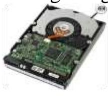
6 - Qattiq disk (Vinchester, HDD ingl. Hard Disk Drive – qattiq disk qurilmasi) kompyuterning tashqi xotirasi bo‘lib, sistema blokiga o‘rnataladi, hamda ma’lumotlarni saqlashda ishlataladi. Vinchestor deganda, silindrsimon germetik idishda joylashtirilgan, bir o‘qqa mustahkamlangan ustma - ust disklar majmui tushuniladi.
