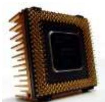
4 - Markaziy protsessor (ingl. central processing unit - CPU, markaziy hisoblash qurilmasi); Arifmetik va mantiqiy amallarni bajaruvchi hamda boshqaruvchi qurilma.
