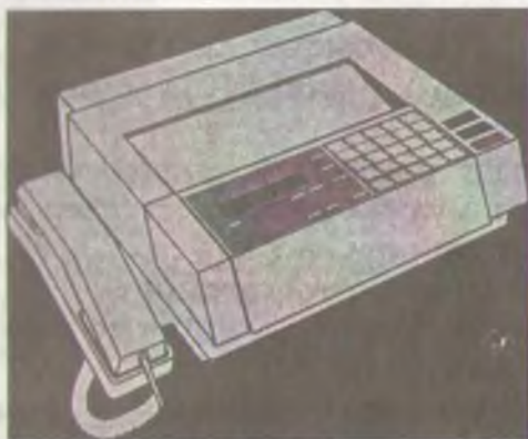
1—расм. Факс— модем —маълумотларни узатиш ва қабул қилиш қурилмаси
