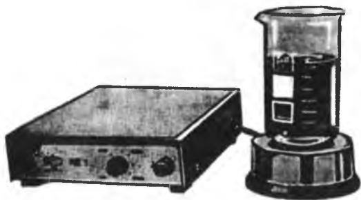
3.11.2-rasm. Germaniyaning MLW firmasi ishlab chiqargan «RE1» markali magnitga ta'sirchan vosita yordamida chayqatuvchi apparat.
