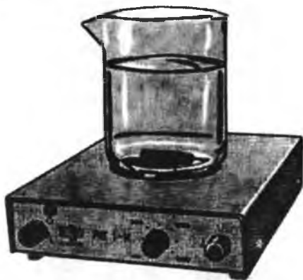
3.11.3-rasm. Germaniyaning MLW firmasi ishlab chiqargan «RE 1-K» markali magnitga ta'sirchan vosita yordamida chayqatuvchi apparat.
