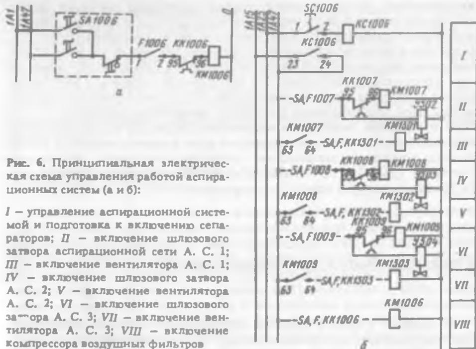
Рис. 6. Принципиальная электрическая схема управления работой аспирационных систем (а и б):
